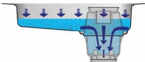
**Renovación del agua de lavado proactiva:** El agua de la cuba de lavado se renueva completamente cada 7 ciclos.
