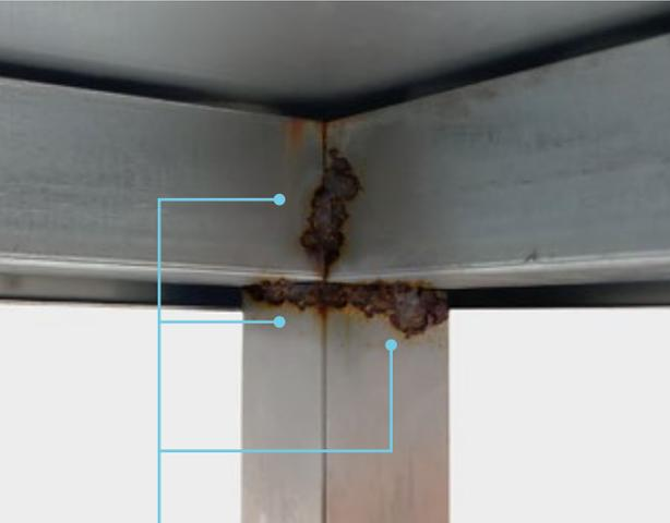
Oxidación por soldadura
